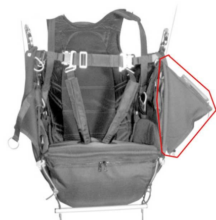
Εικ. 6 Το αεροδυναμικό κάλυμμα (κόκκινο) που κλείνει με φερμουάρ καλύπτοντας όλο το πρόσθιο τμήμα.
