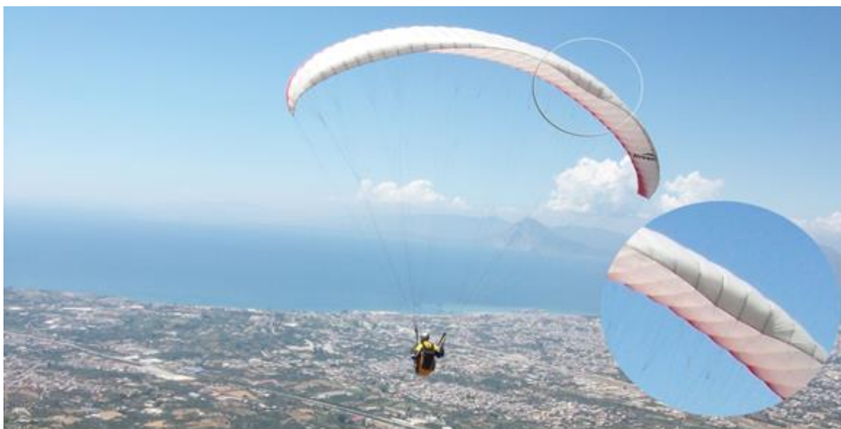
Φωτ. 6 Παραμόρφωση του χείλους εκφυγής δεξιού τμήματος της πτέρυγας
