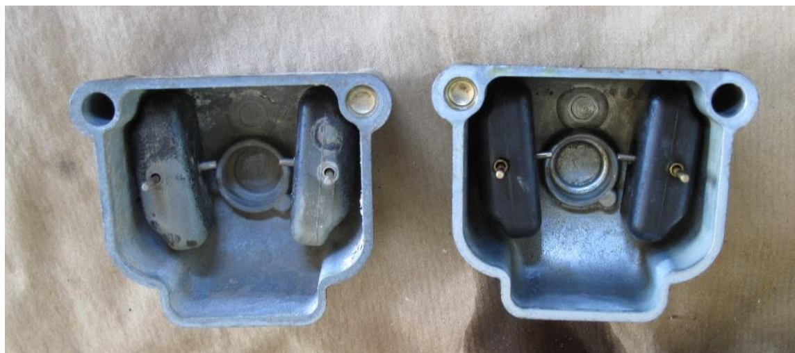
Φωτ. 3 Δοχεία σταθερής στάθμης αναμικτήρα (αριστερός & δεξιός)
