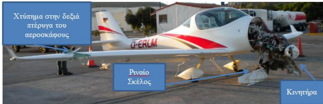
Εικ. 3 Εμφανείς ζημιές αεροσκάφους.
