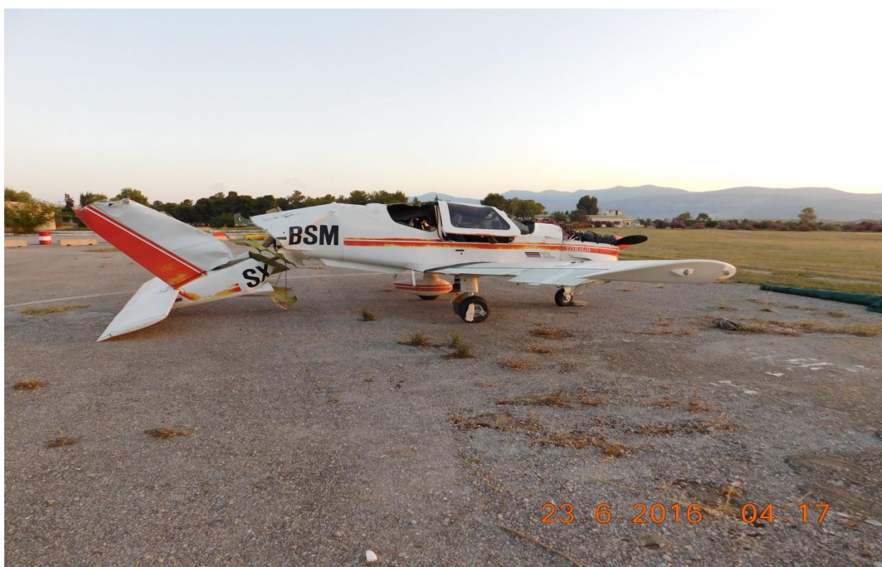
Φωτ. 3 Φθορές στην δεξιά πλευρά του α/φους
