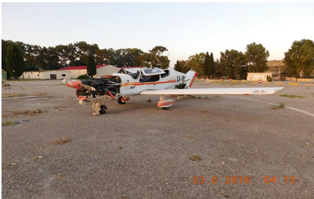
Φωτ. 2 Φθορές στην αριστερή πλευρά του α/φους
