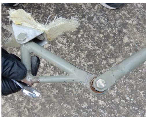
Εικ. 12 Σπασμένο άκρο του bellcrank
