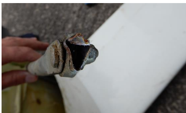
Εικ. 13 Παραμορφωμένο αποσπασμένο άκρο του bellcrank
