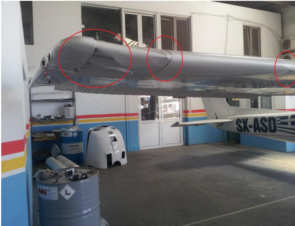
Φωτ. 3 Σημεία στρεβλώσεων δεξιάς πτέρυγας
