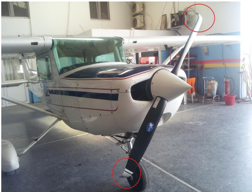
Φωτ. 2 Στρέβλωση ακροπτερυγίων έλικας
