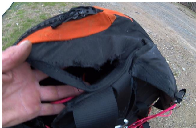
Εικ. 4 Το πλαϊνό σχίσμα του καθίσματος
