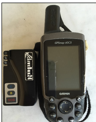
Φωτ. 7: Οι καταγραφείς στοιχείων πτήσης.
