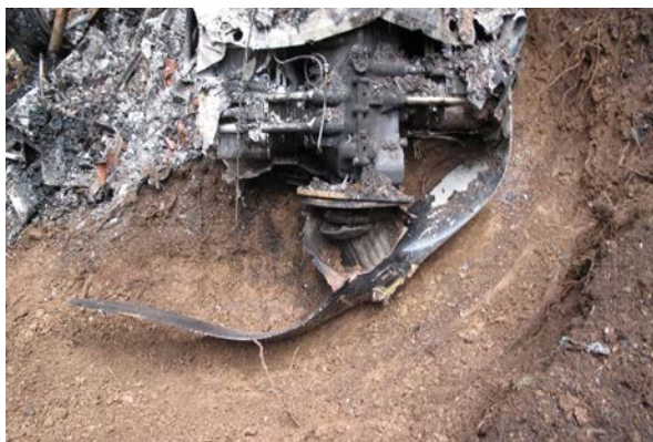
Φωτ.4 Το α/φος στο χώρο της πρόσκρουσης όπου φαίνεται το βύθισμα του κινητήρα στο έδαφος.
