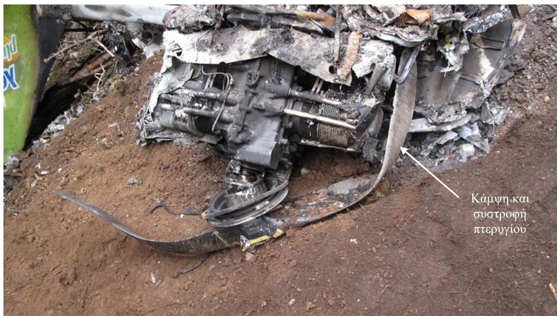
Φωτ. 6 Ο κινητήρας του α/φους στον χώρο του ατυχήματος.
