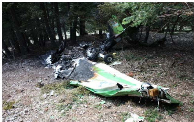
Φωτ. 5 Το αριστερό ακροπτερύγιο όπως έχει συμπίεστεί μετά την πρόσκρουση
