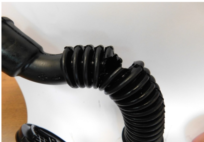
Φωτ. 2: Ο σχισμένος σωλήνας του διαχωριστή ελαίου μετά την αφαίρεσή του από τον κινητήρα
