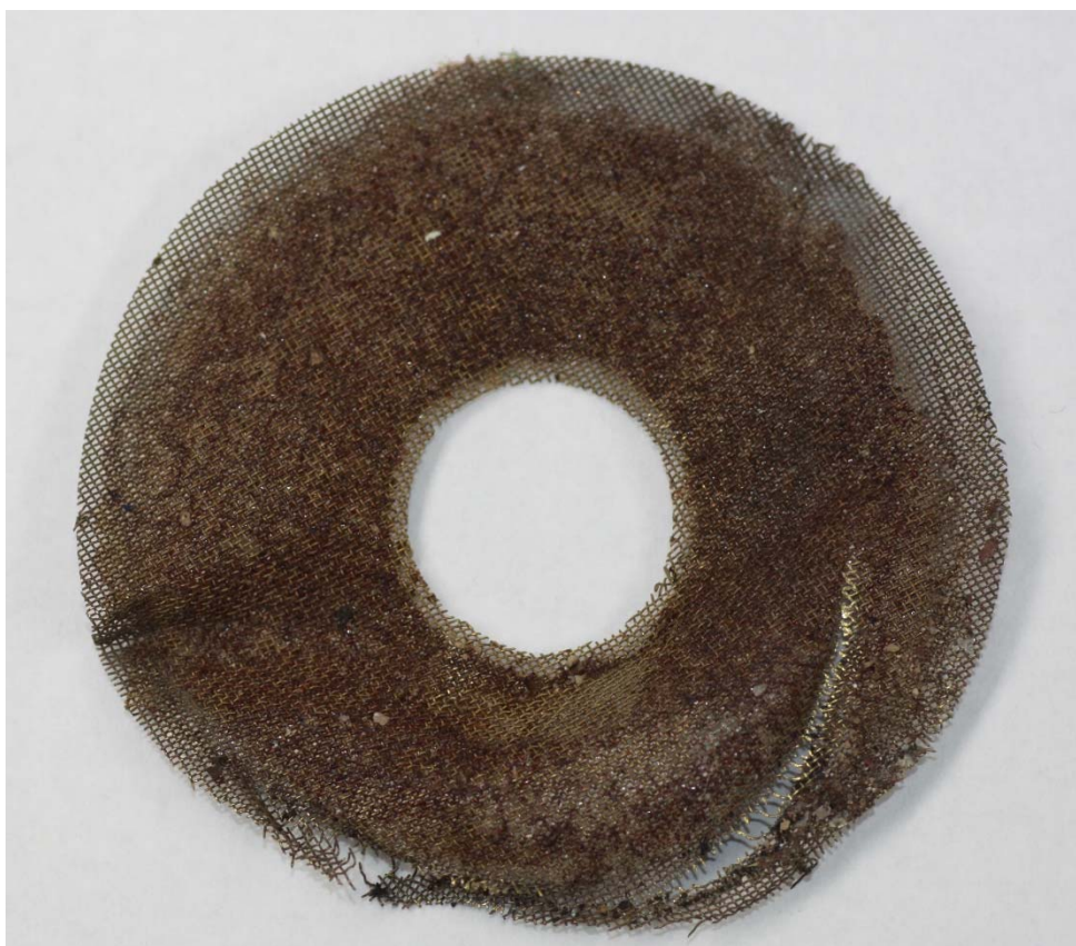
Φωτ. 39: Η πλευρά του φίλτρου που βρίσκεται προς τη πλευρά του φιλτραρισμένου καυσίμου.
