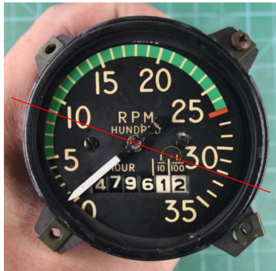
Φωτ. 27: Αντιστοιχία της προέκτασης του αποτυπώματος πάνω στη βαθμονομημένη κλίμακα.
