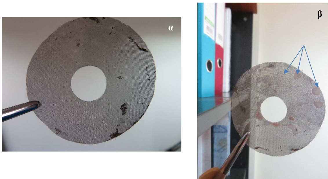
Φωτ. 46: (α) το φίλτρο καυσίμου πριν την επάλειψη της υγρής ακρυλικής ρητίνης και (β) μετά από την επάλειψή της όπως φαίνεται από τα τόξα.
