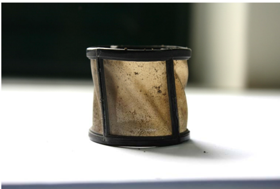
Φωτ. 33: Το φίλτρο της ηλεκτρικής αντλίας καυσίμου κατά την μακροσκοπική εξέτασή του με τις ελαφρές επικαθήσεις του.
