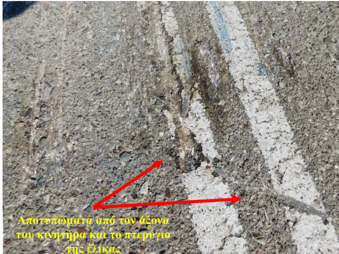
Φωτ. 12: Το σημείο επαφής του α/φους με το οδόστρωμα.
