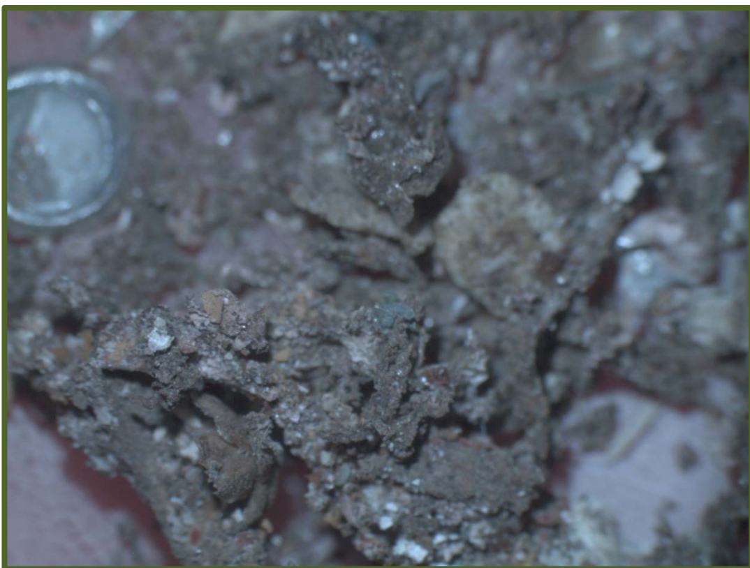
Φωτ. 36: Λεπτομέρεια Α, Λήψη από στερεομακροσκόπιο των επικαθήσεων στη δεξιά δεξαμενή καυσίμου κατά τον εργαστηριακό έλεγχο.
