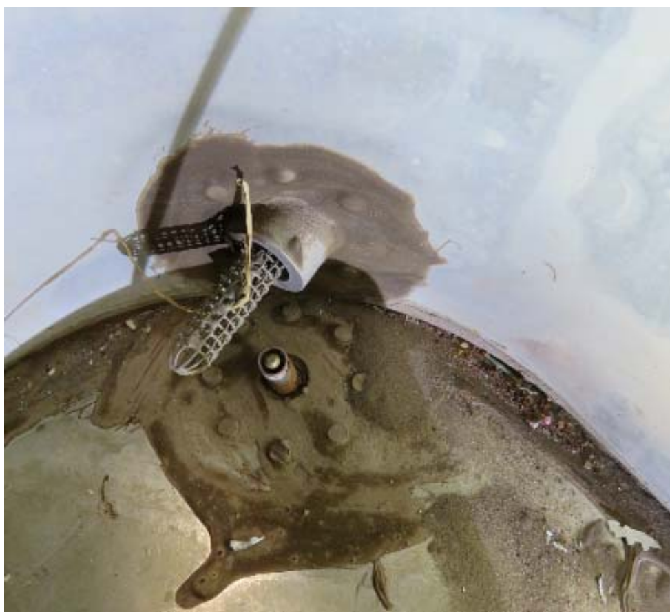
Φωτ. 37: Δείγμα των επικαθήσεων της αριστερής δεξαμενής
