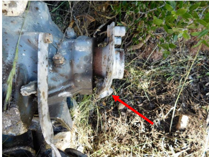
Φωτ. 16 : Η παραμόρφωση του άξονα του κινητήρα στο σημείο ενώσεως με την έλικα.
