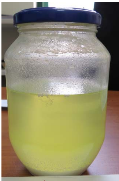
Φωτ. 43: Το διάλυμα 6.6% ακρυλικής ρητίνης αμέσως μετά την παρασκευή του.
