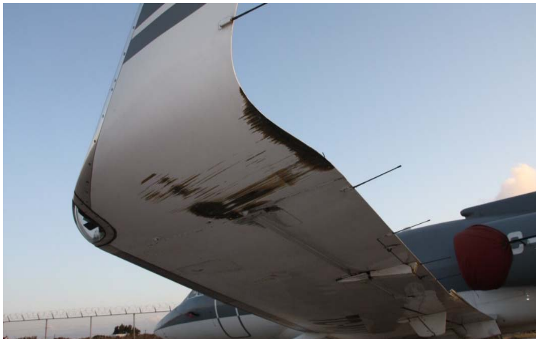
Φωτ. 1: Ζημιά στο ακροπτερύγιο (winglet) της αριστερής πτέρυγας.
