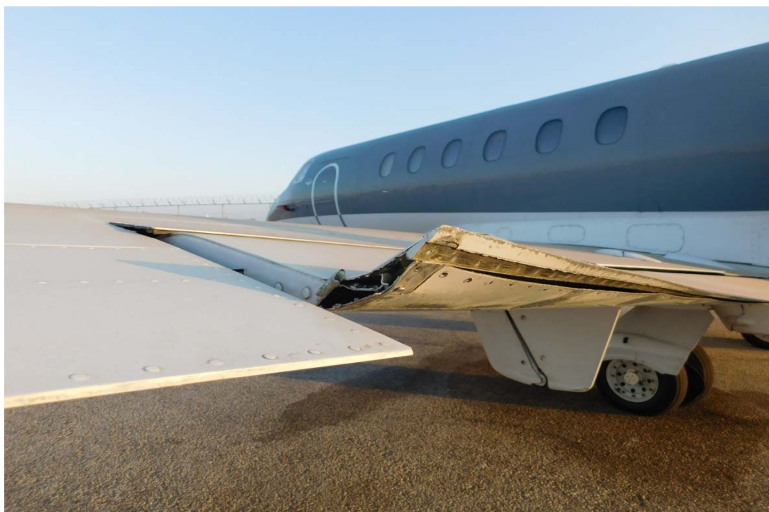
Φωτ. 1: Ζημιά στο ακροπτερύγιο (winglet) της αριστερής πτέρυγας.
