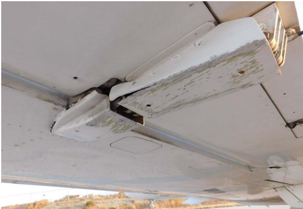
Φωτ. 3: Ζημιά στο αεροδυναμικό κάλυμμα του πτερυγίου κλίσεως (aileron) στην κάτω επιφάνεια της αριστερής πτέρυγας.
