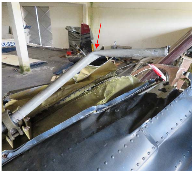
Φωτ. 44: Η συστροφή του Άξονα Περιστροφής του Ουραίου Στροφείου(κόκκινο βέλος).
