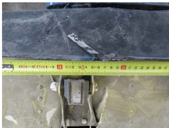
Φωτ. 30: Το χτύπημα μήκους 5 cm στο χείλος προσβολής του λευκού Πτερυγίου και της ίδιας διάστασης βάση του φορέα στήριξης του Τριβέα του Άξονα Περιστροφής του Ουραίου Στροφείου.
