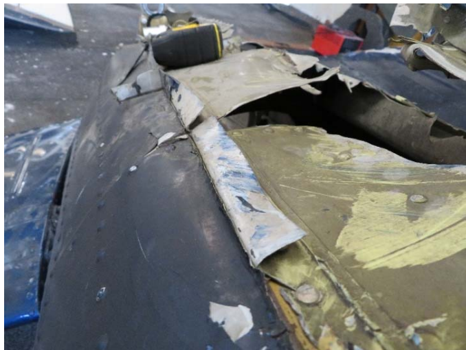
Φωτ. 9: Παραμορφώσεις στην περιοχή του Άξονα Περιστροφής του Ουραίου Στροφείου. Η φωτογραφία έχει κατεύθυνση προς τα εμπρός.
