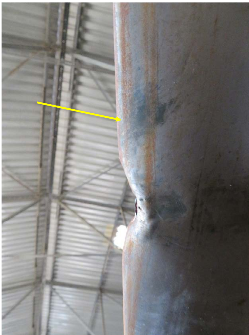
Φωτ. 31: Αποτύπωμα χρώματος του Ε/Π στο Πτερύγιο, από την πρόσκρουση του στο Ουραίο Τμήμα (κίτρινο βέλος).
