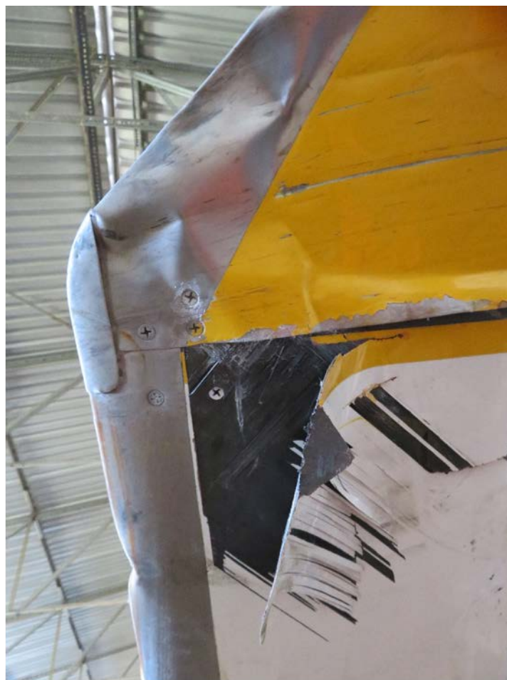
Φωτ. 32: Το άκρο του λευκού Πτερυγίου με τις υφιστάμενες παραμορφώσεις
