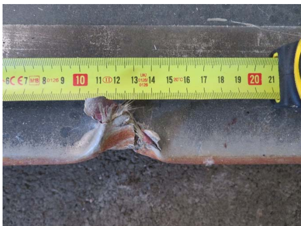
Φωτ. 30: Το χτύπημα μήκους 5 cm στο χείλος προσβολής του λευκού Πτερυγίου και της ίδιας διάστασης βάση του φορέα στήριξης του Τριβέα του Άξονα Περιστροφής του Ουραίου Στροφείου.
