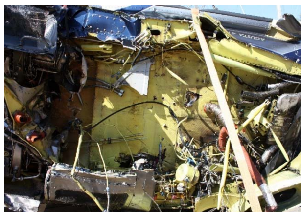
Φωτ. 7: Η περιοχή του κυρίως Γραναζοκιβωτίου.
