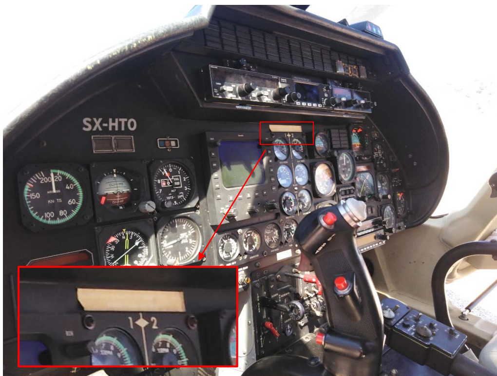
Φωτ. 42: Η αρίθμηση των κινητήρων στον πίνακα οργάνων.
