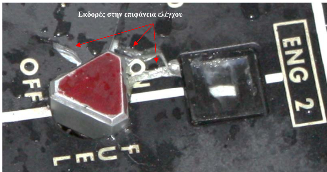
Φωτ. 5: Ο διακόπτης της Βαλβίδας Καυσίμου του δεξιού Κινητήρα.
