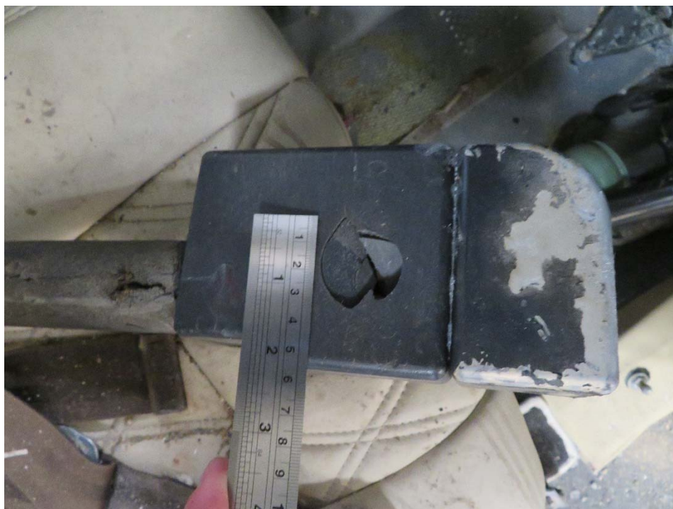
Φωτ. 40: Η διάτρηση του μοχλού ελέγχου Collective.
