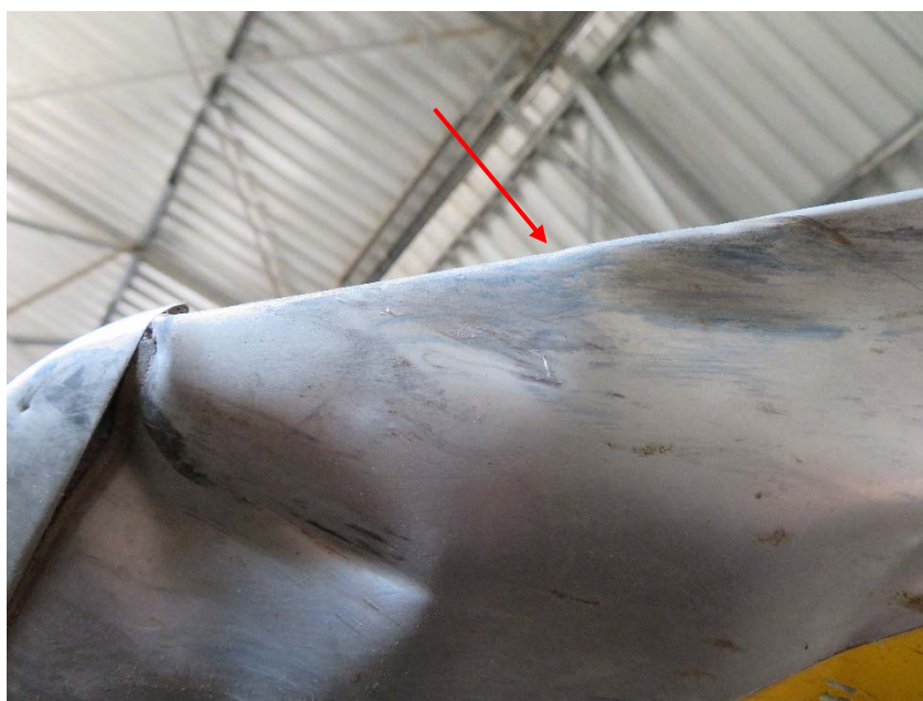
Φωτ. 33: Το άκρο του λευκού Πτερυγίου με χρωματικά αποτυπώματα από την πρόσκρουση του στο Ουραίο τμήμα (κόκκινο βέλος).
