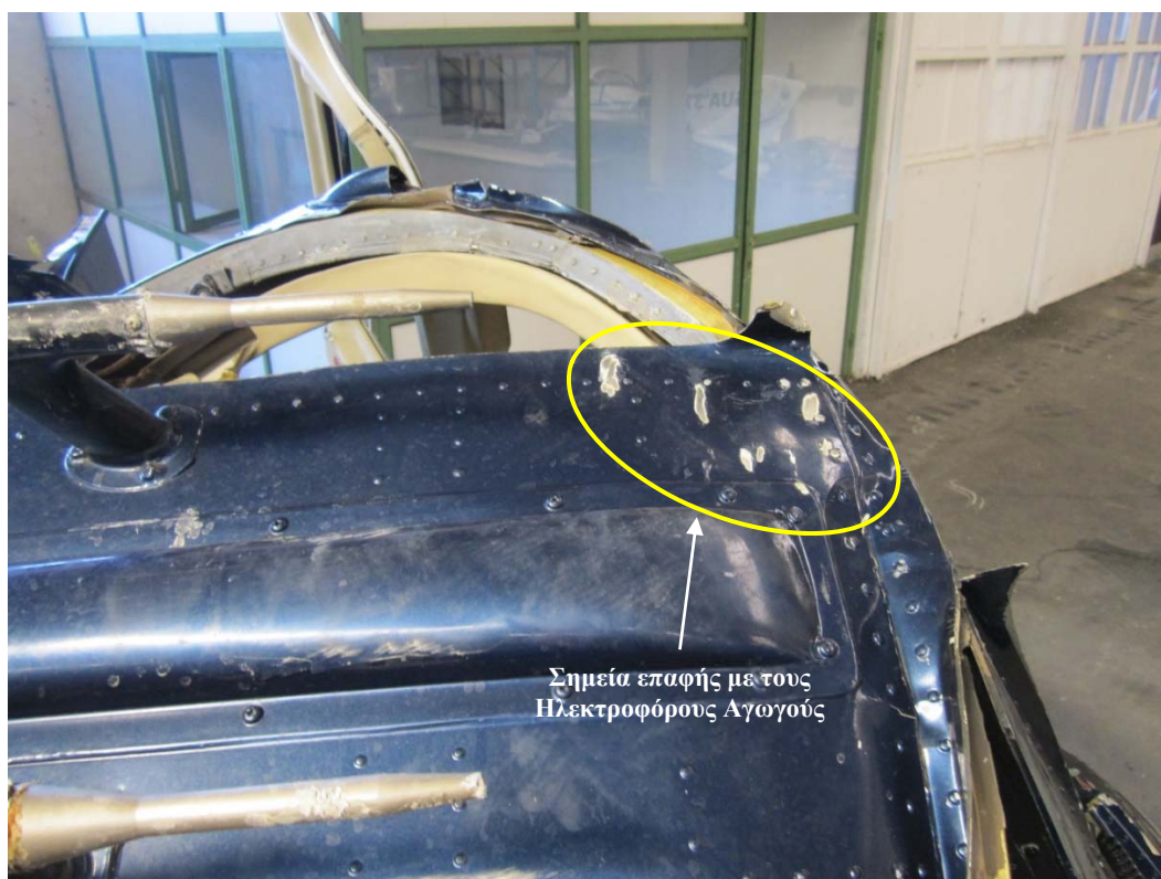
Φωτ. 22: Τα σημεία επαφής του άνω μέρους του πιλοτηρίου του Ε/Π με τους Ηλεκτροφόρους Αγωγούς.
