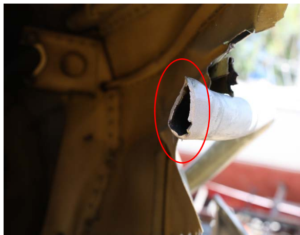
Φωτ. 45: Το σημείο θραύσης του Άξονα του Ουραίου Στροφείου.
