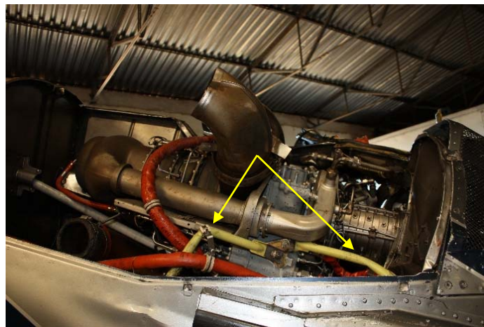
Φωτ. 15 Οι παραμορφωμένες εδράσεις του Κινητήρα (κίτρινα βέλη).
