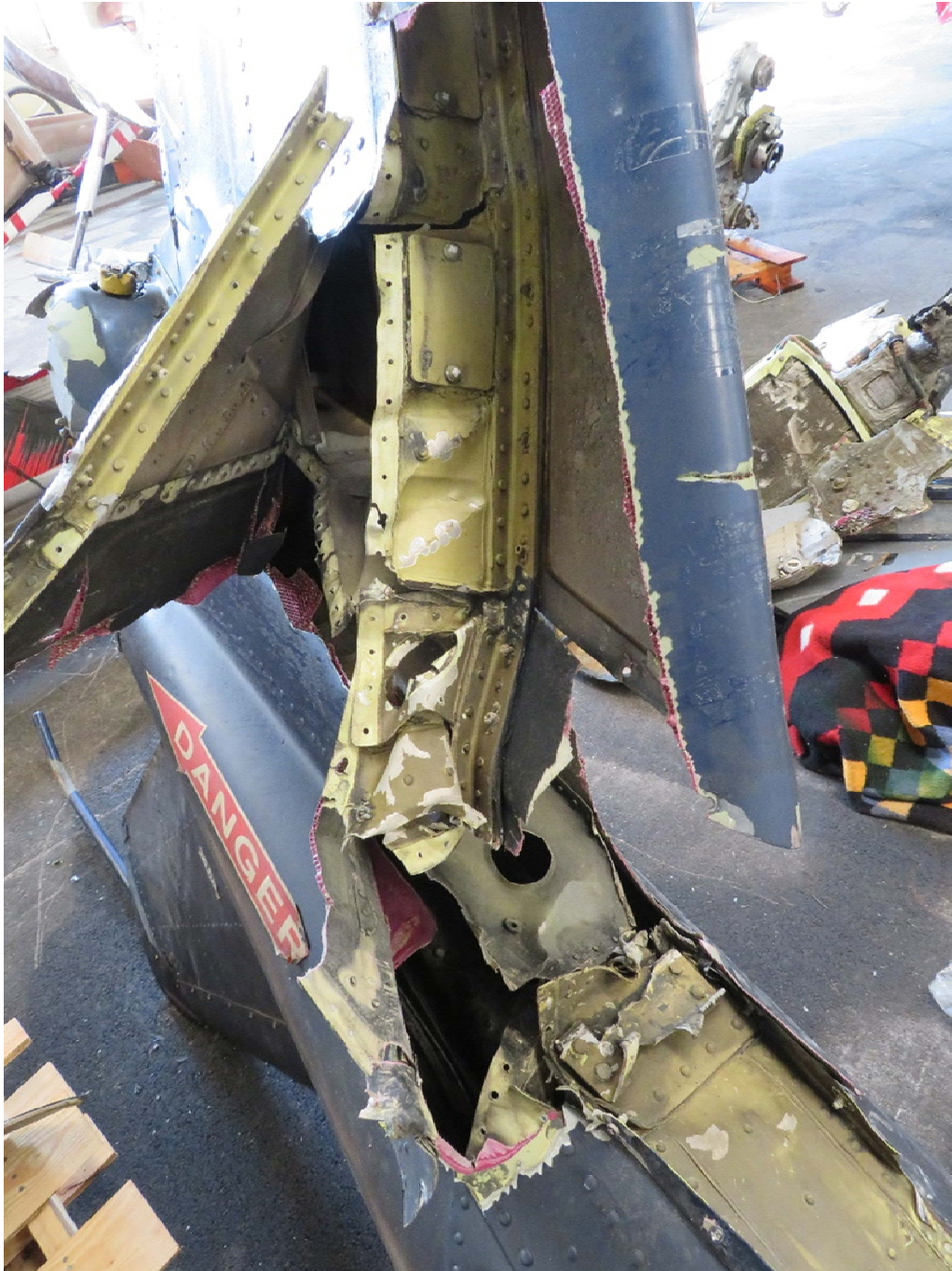
Φωτ. 29: Παραμορφώσεις του κάθετου σταθερού του Ουραίου Τμήματος.
