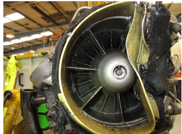
Φωτ. 14: Η εισαγωγή του Συμπιεστή του δεξιού Κινητήρα με την παραμόρφωση του Εμπρόσθιου Υποστηρικτικού Τμήματός του.
