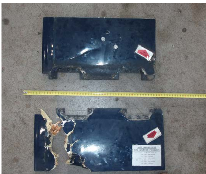
Φωτ. 1: Δεξιά (α) και αριστερή (β) θύρα του ριναίου τροχού μετά το συμβάν.
