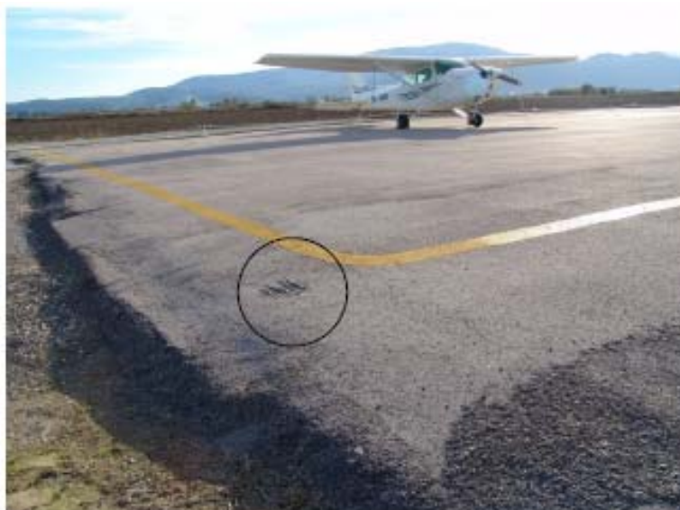
Φωτ. 3. Σημείο επαφής του ακροπτερυγίου της έλικας με την ασφάλτινη επιφάνεια.
