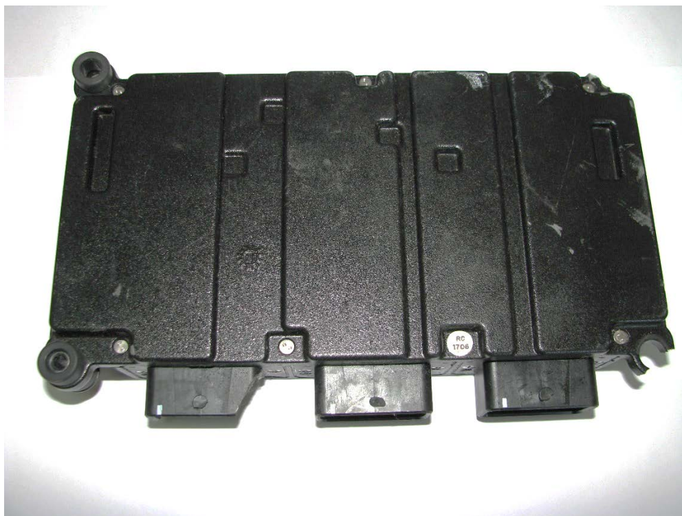
Φωτ. 2: Η μονάδα ελέγχου του κινητήρα του α/φους .
