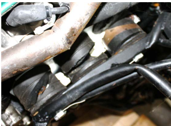
Φωτ. 6: Οι κομμένοι ελαστικοί αποσβεστήρες της αριστερής κάτω βάσης του κινητήρα.
