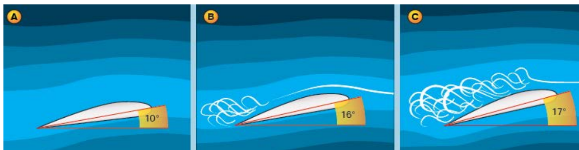
Εικ. 9: Η αποκόλληση του οριακού στρώματος (c) σαν αποτέλεσμα της αύξησης της γωνίας προσβολής της πτέρυγας σε τιμή μεγαλύτερη από την κρίσιμη. Η τιμή της κρίσιμης γωνίας προσβολής του ανωτέρω σχήματος είναι ενδεικτική.
