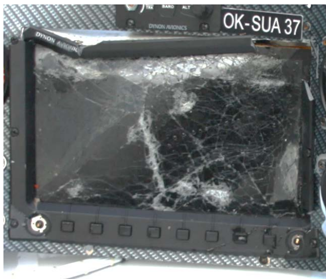
Φωτ. 1: Η συσκευή Sky View της Dynon Avionics SV-D1000T στο χώρο του ατυχήματος
