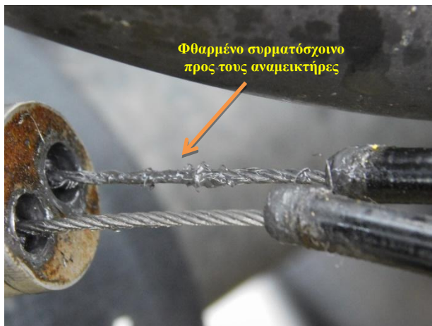
Φωτ.2: Κατάσταση συρματόσχοινων ελέγχου ισχύος και των παρελκυμένων των αναμεικτήρων.
