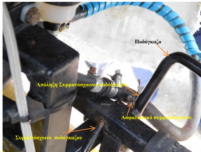
Φωτ. 4: Το 'ποδόγκαζο' με τα σημεία στήριξης των παρελκόμενων του
