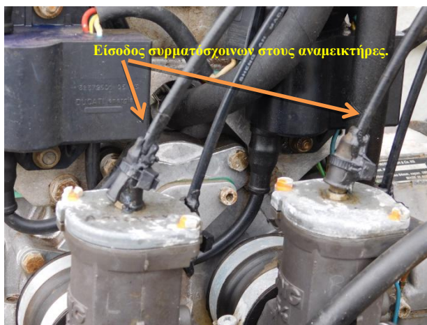
Φωτ.3: Πορεία των συρματόσχοινων ελέγχου ισχύος
