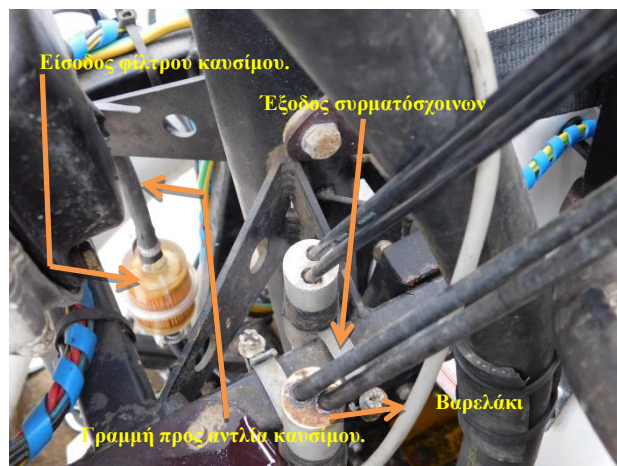
Φωτ.3: Πορεία των συρματόσχοινων ελέγχου ισχύος
