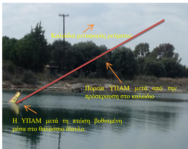
Φωτ.1 : Η ΥΠΑΜ στο σημείο πτώσης και το κομμένο μη τροφοδοτούμενο ηλεκτροφόρο καλώδιο
