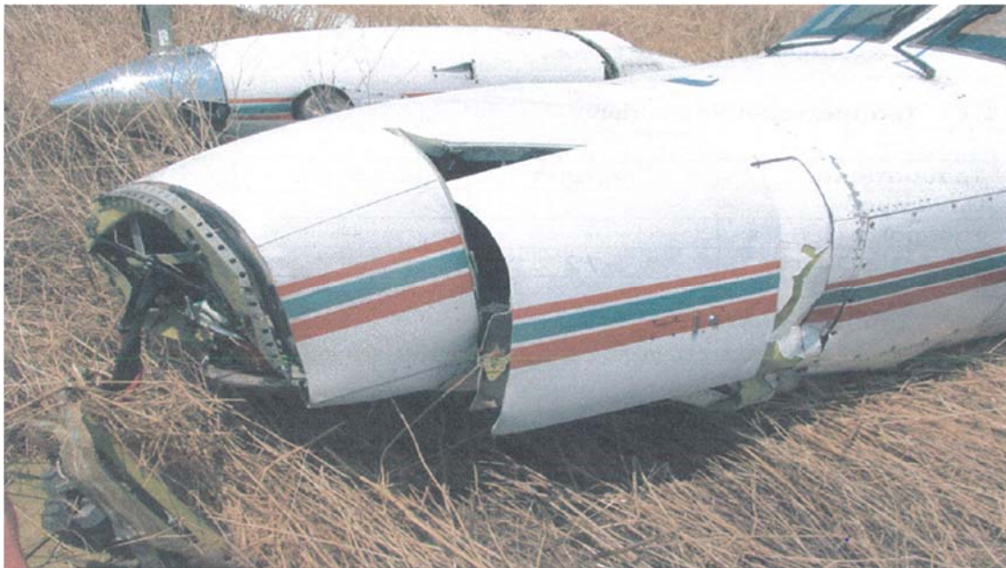
Φωτο. 3: Το μπροστινό μέρος της ατράκτου και δεξιός κινητήρας SX-AVC.
