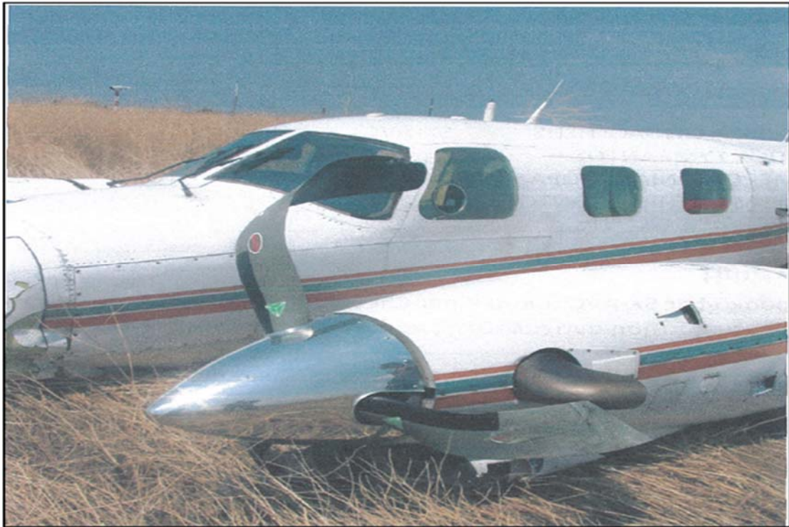
Φωτο. 2: Άτρακτος και αριστερός κινητήρας του SX-AVC.
