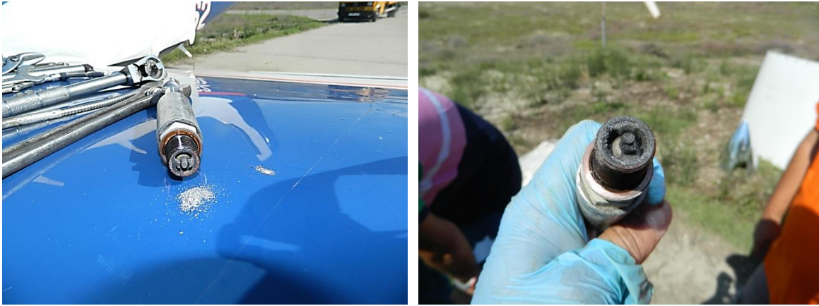
Φωτ. 3: Οι Σπινθηριστές των κυλίνδρων Νο2 και Νο6 με τις ενανθρακώσεις.
