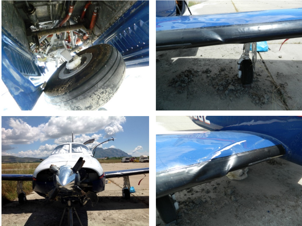
Φωτ. 1 Χαρακτηριστικές ζημιές που υπέστη το α/φος κατά την αναγκαστική προσγείωση.
