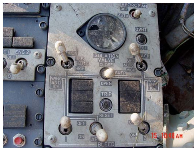
Φωτογρ. – Πίνακας Ελέγχου Κλιματισμού
