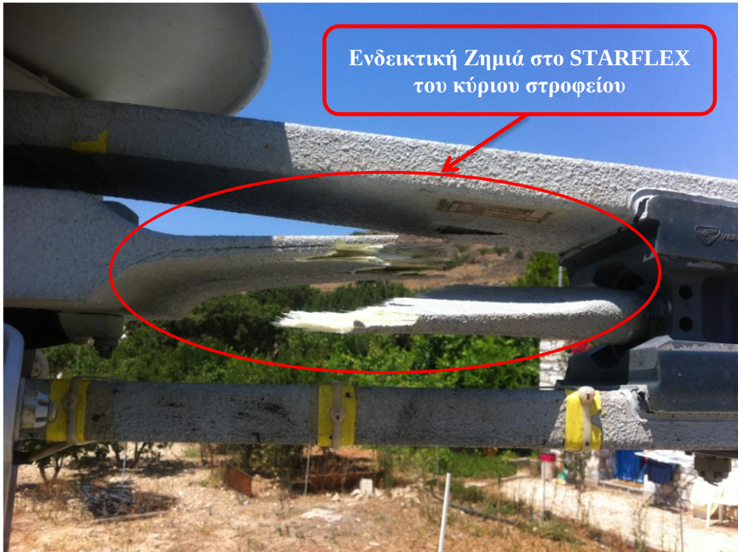
Εικ.2: Ζημιά στο STARFLEX του κύριου στροφείου
