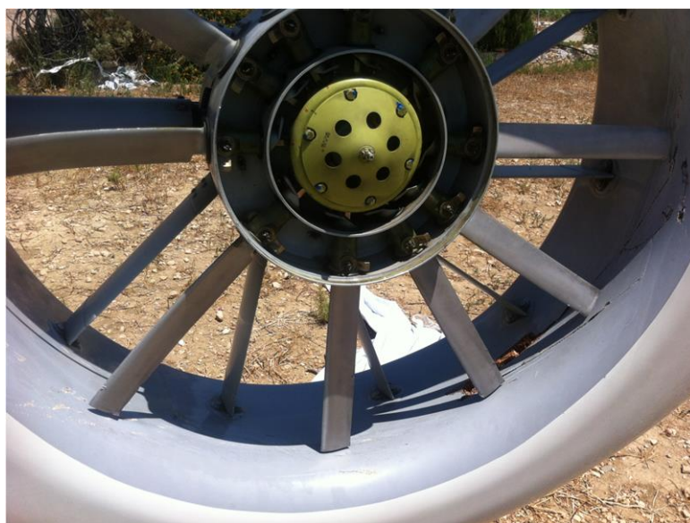
Εικ.3: Το ουραίο στροφέιο, τύπου FENESTRON, όπως ήταν την ώρα του συμβάντος
