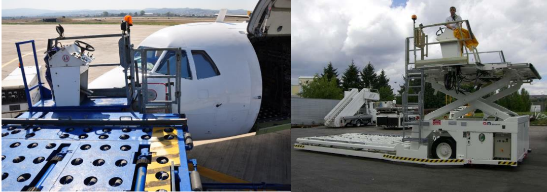
Φωτ. 4 Θέσης Οδήγησης οχήματος φορτοεκφόρτωσης
