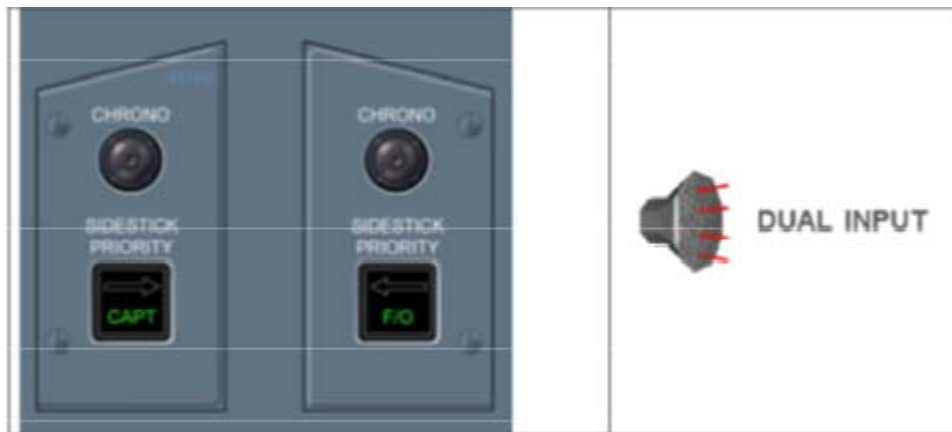
Εικ. 19: Επέμβαση στα χειριστήρια και των δύο μελών του πληρώματος θαλάμου διακυβέρνησης, χωρίς προτεραιότητα και με ενεργοποίηση ηχητικού μηνύματος “DUAL INPUT”.
