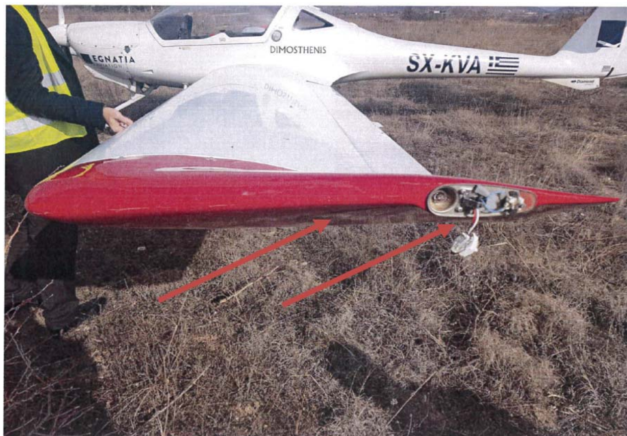
Φωτ. 4: Ζημιές στο αριστερό ακροπτερύγιο.
